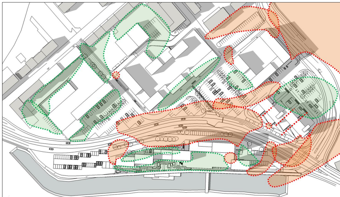
Figur 12-18 Markering af de områder, hvor bygningerne hhv. accelerer vinden (rød) og hvor de skaber læ (grøn).
