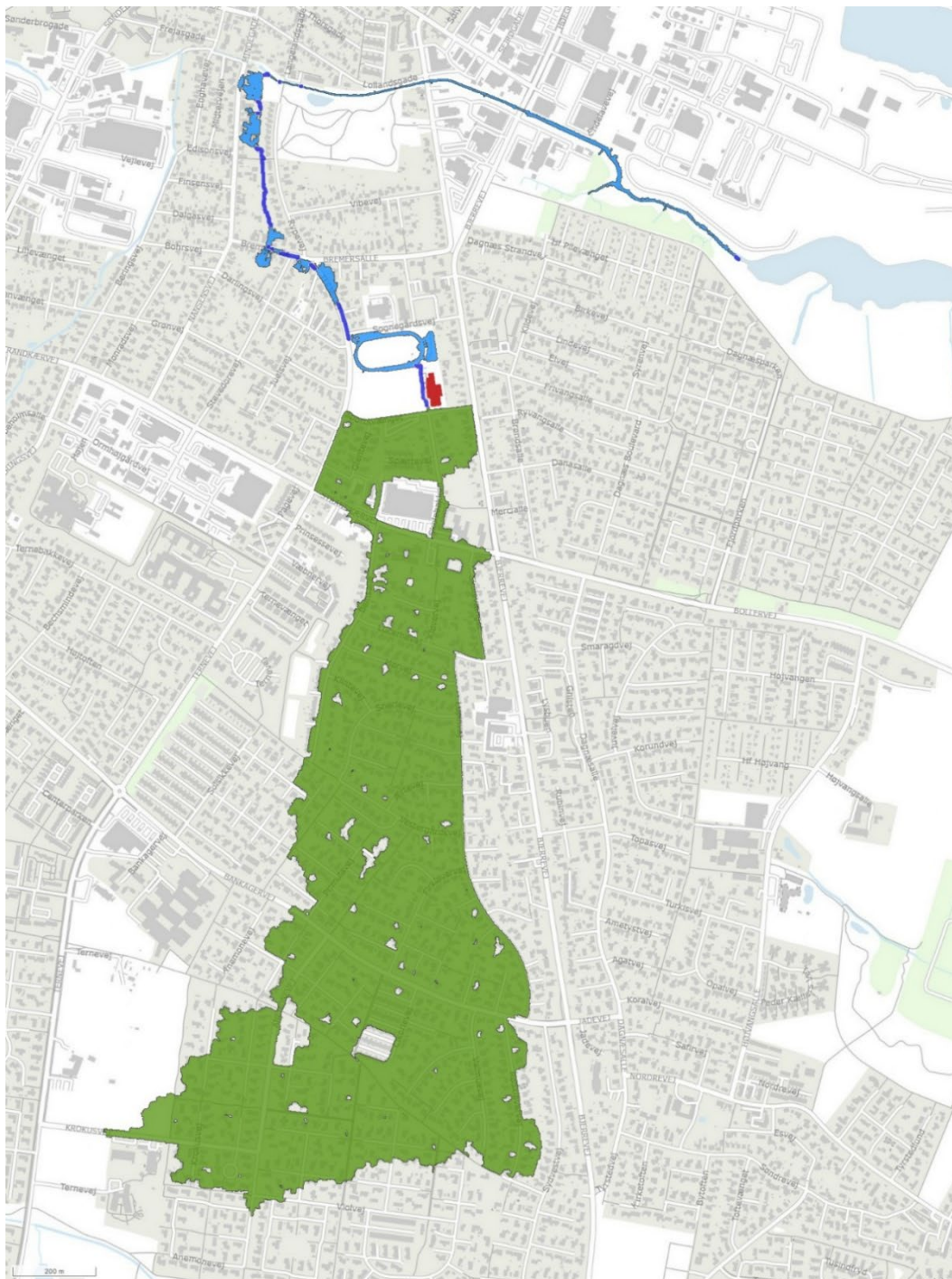
Figur X1 – Afvandingsopland (grøn) for krydset Sportsvænget/Skolebakken ved en 100-årshændelse. Der forventes at strømme ca. 7.500 m 3 vand gennem krydset og forbi hallen ved en sådan hændelse. Overfladevandets strømningsvej fra hallen mod fjorden vises med blå. Hallen vises med rødt. Strømretning er syd mod nord. Fra simulering i Scalgo.
