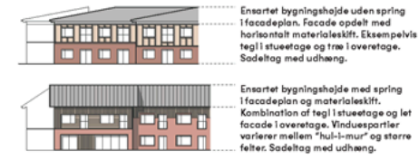
Facadeprincipper for plejecenter
