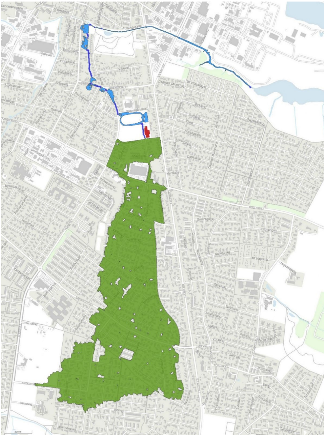
Figur X1 – Afvandingsopland (grøn) for krydset Sportsvænget/Skolebakken ved en 100-årshændelse. Der forventes at strømme ca. 7.500 m 3 vand gennem krydset og forbi hallen ved en sådan hændelse. Overfladevandets strømningsvej fra hallen mod fjorden vises med blå. Hallen vises med rødt. Strømrretning er syd mod nord. Fra simulering i Scalgo.
