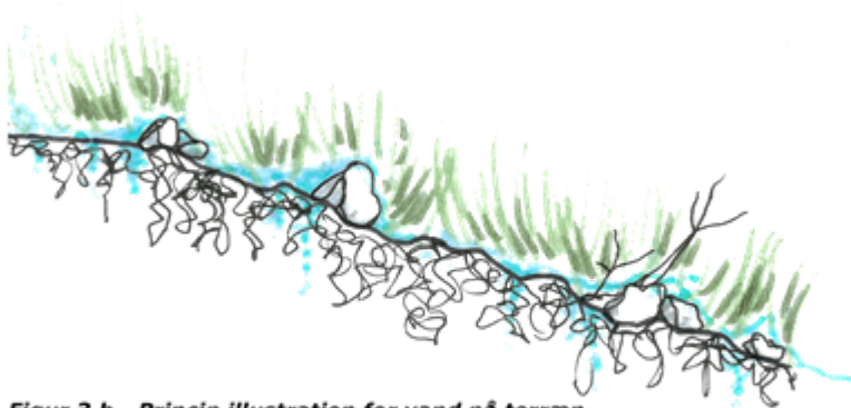
Figur 3.b - Princip illustration for vand på terræn Vand der ledes på terræn forsinkes naturligt af hhv. nedsivning samt den ujævne overflade og forhindringer som f.eks. sten og grene. Forsinkelsen kan også være med til at gøre fordampning af vandet fra terræn muligt.
