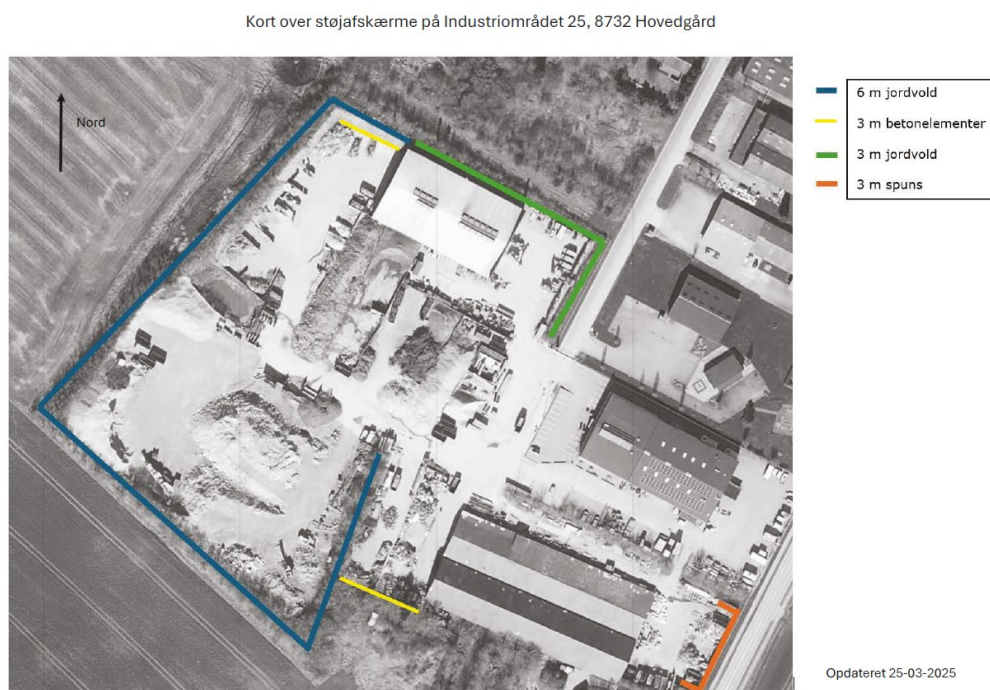
Figur 1. Eksisterende støjvolde og støjskærme
