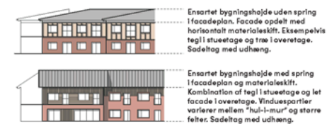
Facadeprincipper for plejecenter
