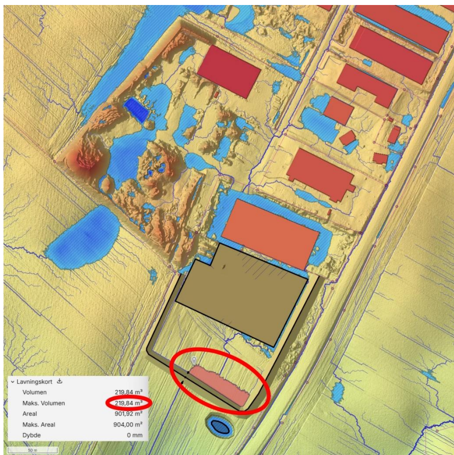
Figur 22: Udklip fra SCALGO Live, hvor strømningsveje ved skybrudshændelse efter etablering af ny oplagsplads er vist.
