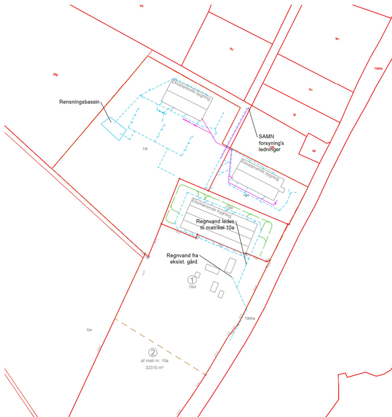
Figur 5: Internt kloakanlæg indenfor området ved P. Olesen. De lyseblå stiplede linjer er eksisterende regnvandsledninger. De pink linjer er eksisterende spildevandsledninger. Den mørkegrønne stiplede linje er eksisterende drænledning. Den brune stiplede linje er afgrænsning af fremtidige matrikel 10a1.
