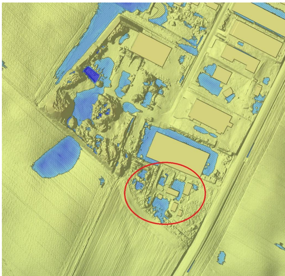
Figur 21: Udklip fra SCALGO Live, hvor eksisterende lavninger er markeret, ca. 200m 3 , som skal opretholdes.
