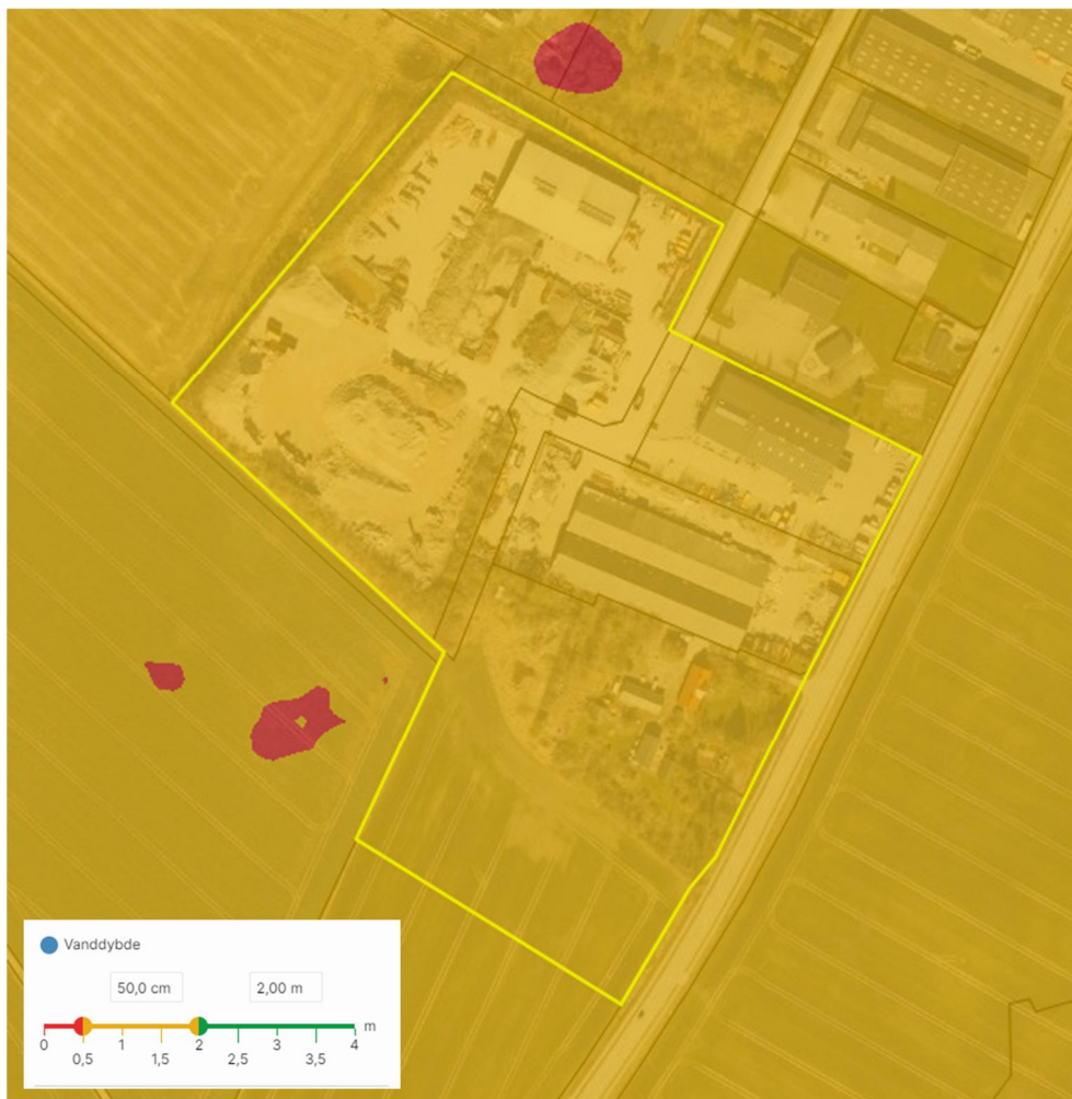
Figur 14: Kortet viser dybden af det terrænnære grundvand. Dette er gjort ved en farveinddeling af dybden under terræn. Udklip fra SCALGO Live.
