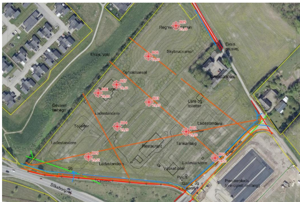
Figur 3-2 Boringsoversigt. Kilde: Geoteknisk Rapport, Franck Miljø & Geoteknik
