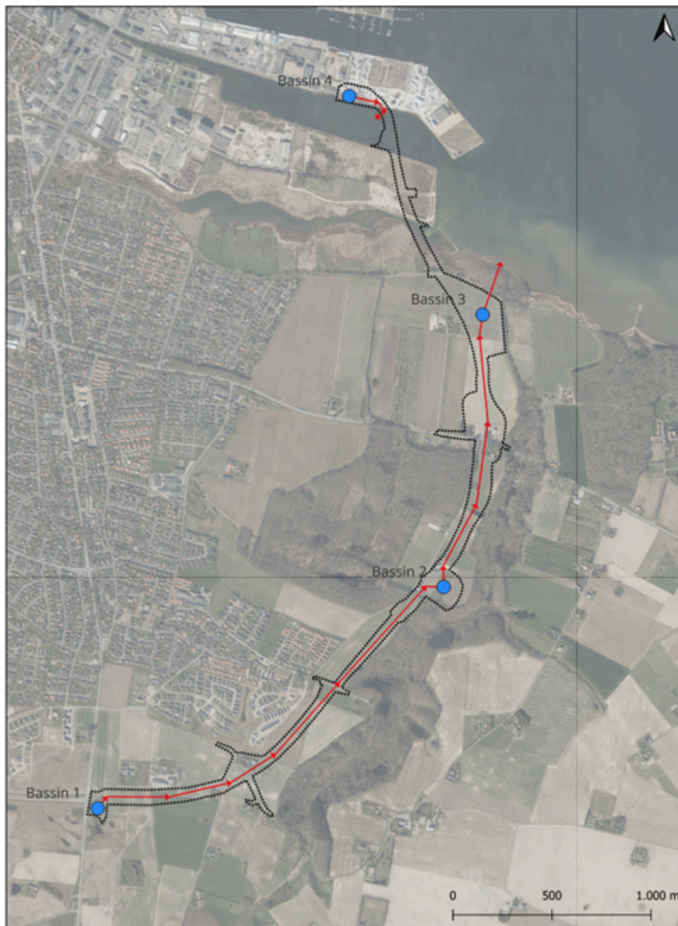
Oversigtskort med principiel placering af regnvandsbassiner og udløbspunkter.
