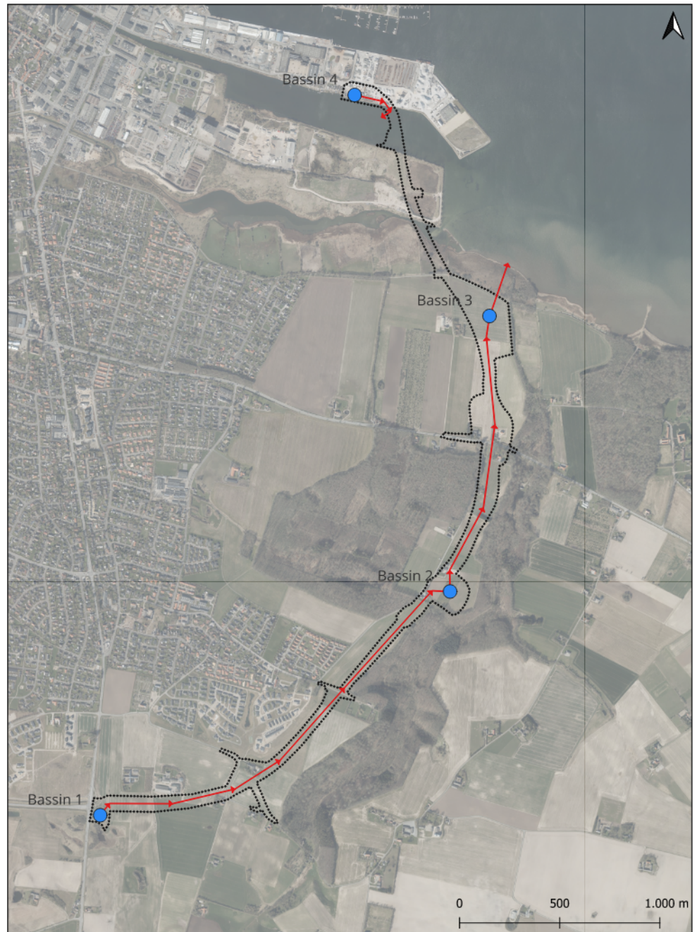
Figur 11-2 Oversigtskort med placering af regnvandsbassiner samt udløbspunkter.
