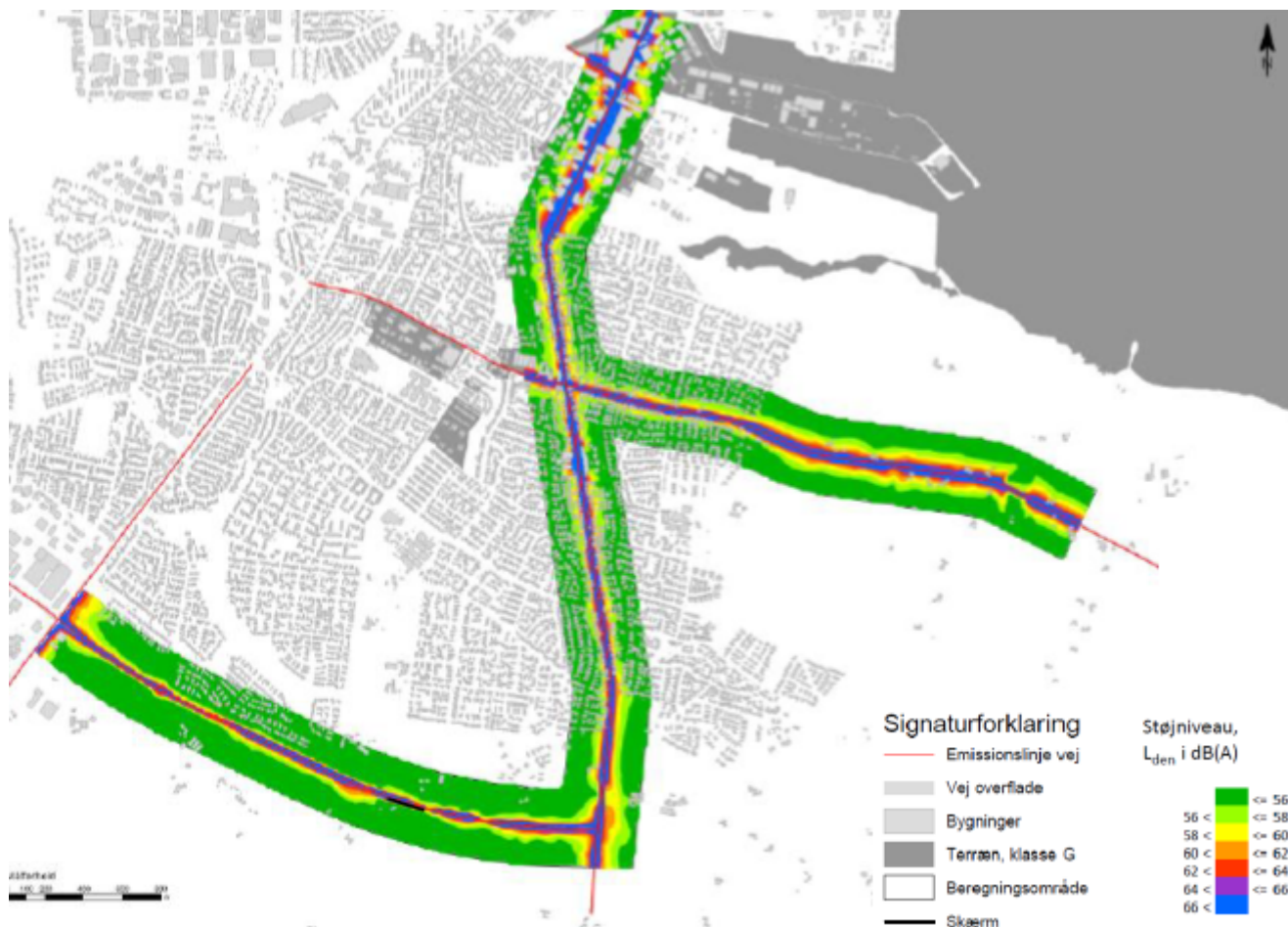
Figur 7-1 Beregnet støjdbredelse for referencescenariet, som omfatter en fremskrivning af trafikken til 2030.
