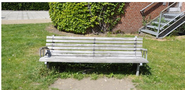
Bænk i park: simpel bænk med trælameller og galvaniserede stålvan- ger, som eksisterende, Aarhus-bænken eller ligestillede.
