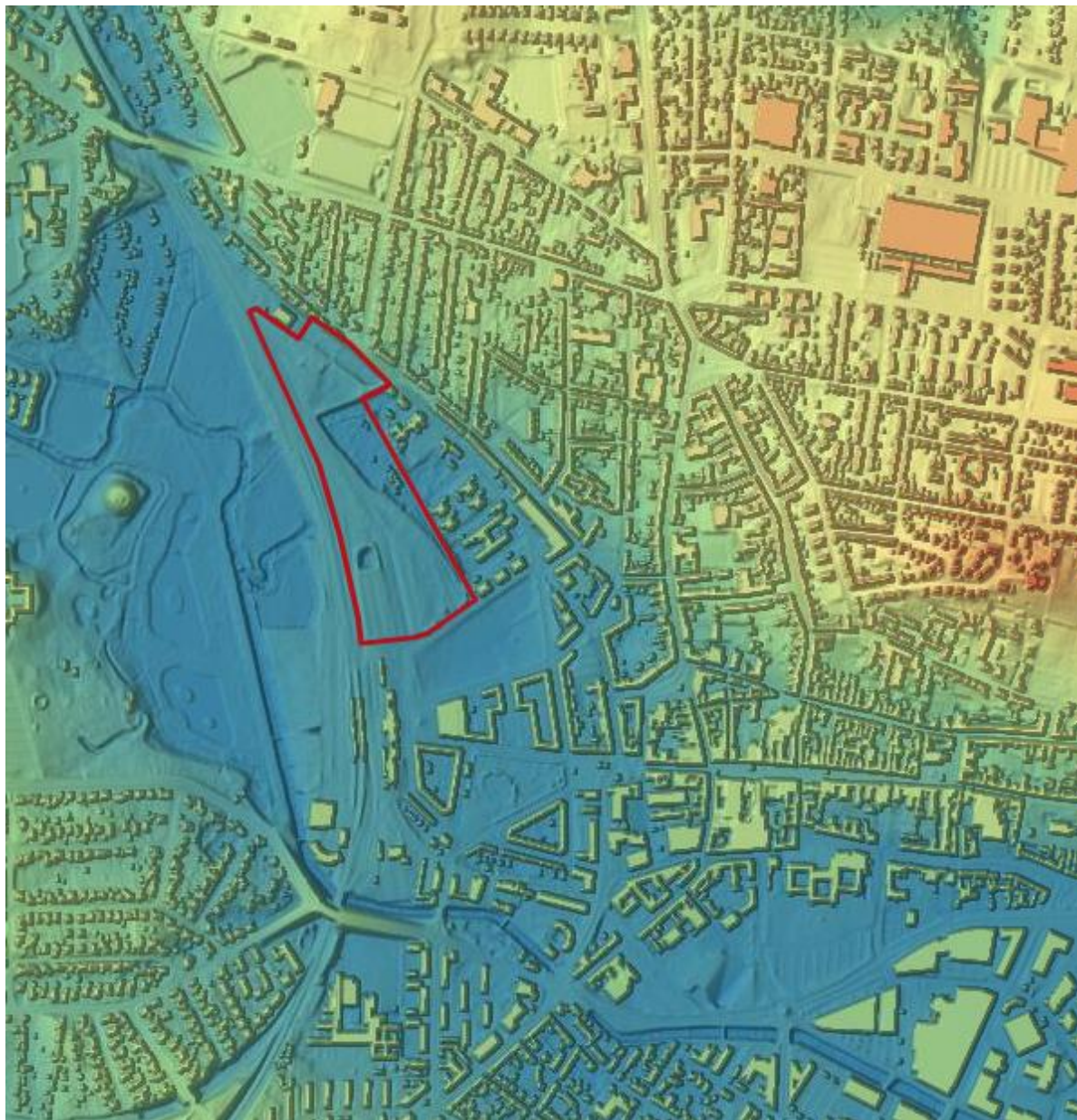
Figur 2 Koteplan (fra Scalgo) af opland omkring projektområdet (markeret rød).
