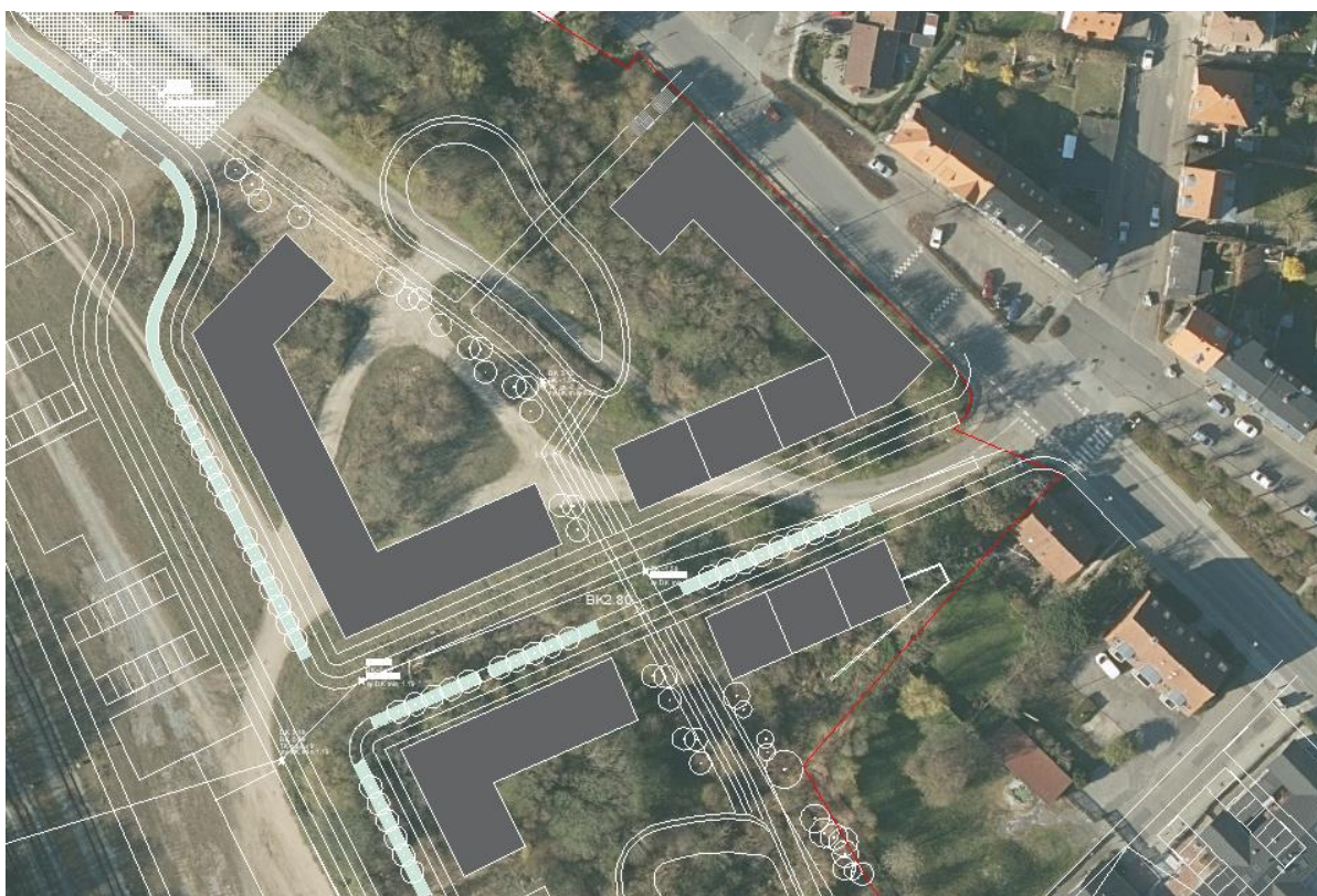
Figur 8 – Geometri for projektområdet med vejanlæg og fodaftryk for bygninger
