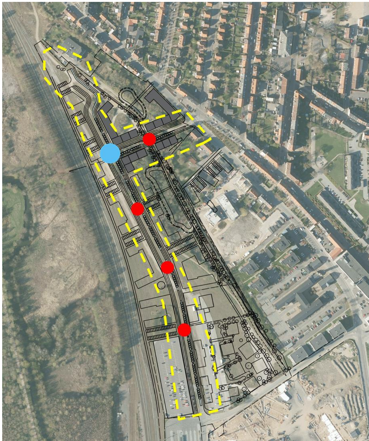
Figur 11 – Forslag til zone for anbefalet hastighed (gul), samt placering af hævet flade (blå) og bump (rød)
