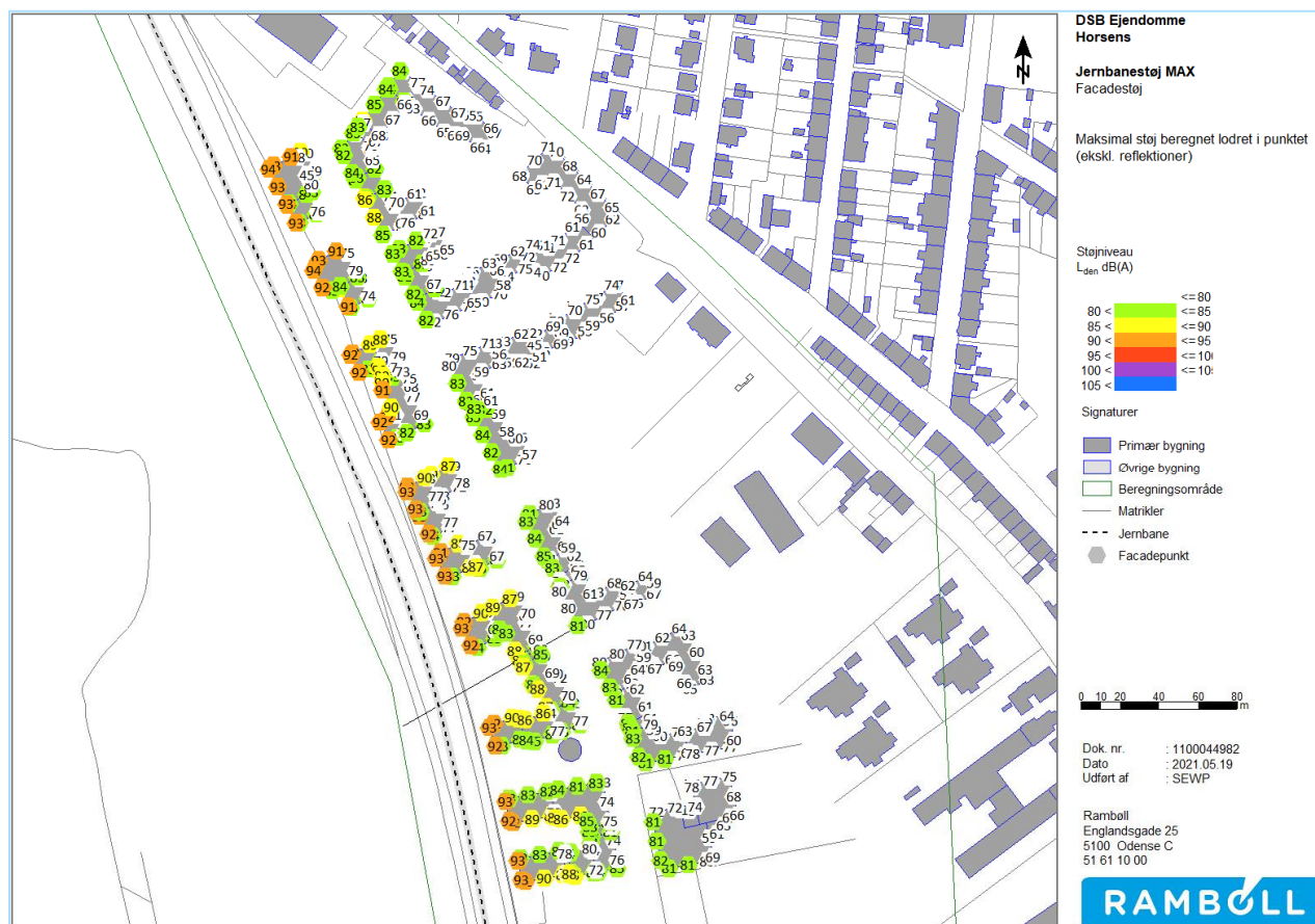
Figur 10 - Facadestøjniveau på boliger fra maksimal tog passage. Viser den højeste støj som er beregnet for etagerne lodret i punktet.
