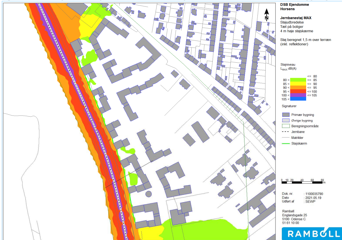
Figur 14 - Maxstøjniveau støjdbredelse med 4 m høje reflekterende skærme imellem bygninger
