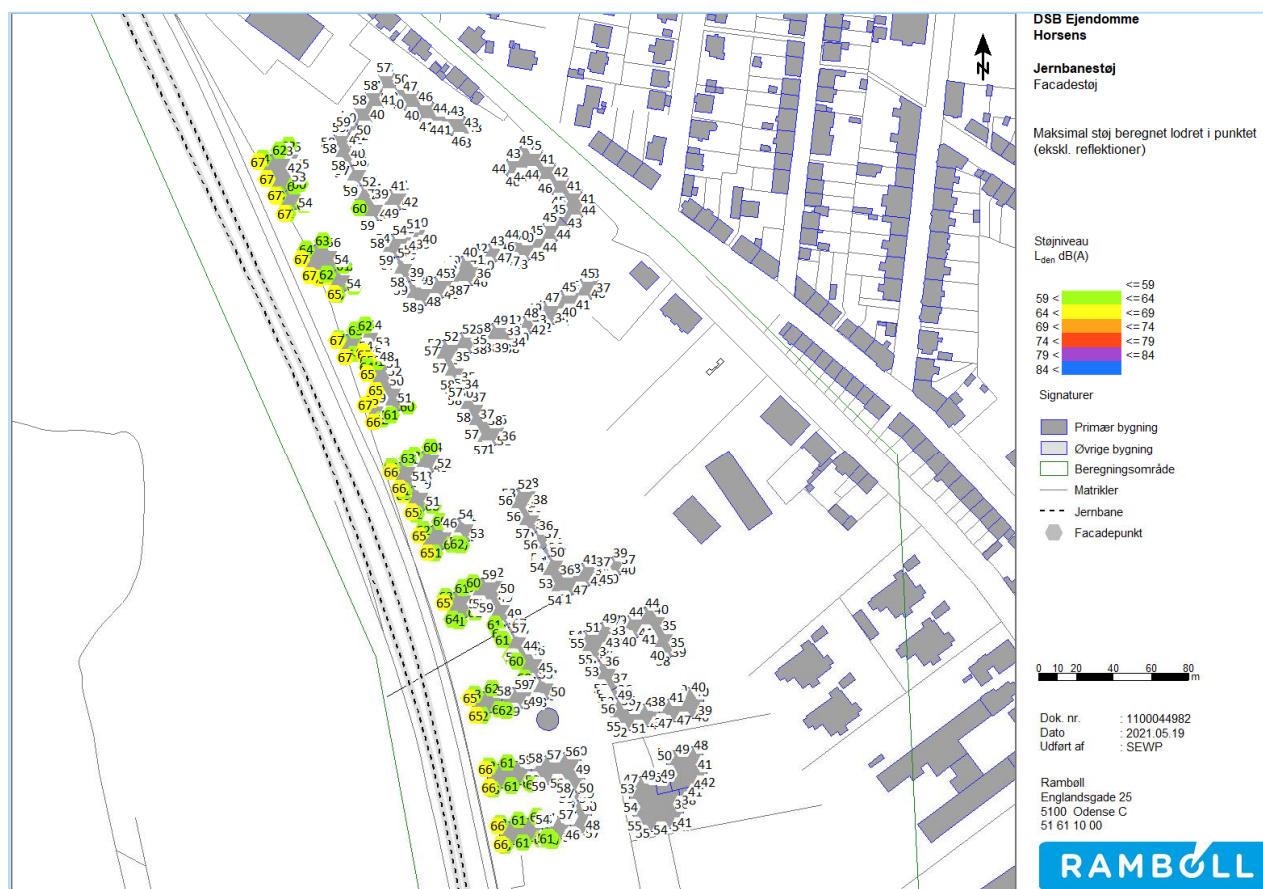
Figur 7 - Facadestøjniveau jernbanestøj. Viser den højeste støj som er beregnet for etagerne lodret i punktet.
