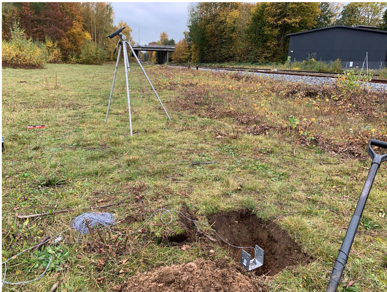
Figur 2: Måleopstillingen med nedbanket spyd. Der er gravet cirka 40 cm ned i hullet, hvorpå spyddet er slået ned i underlaget, som på dette sted bestod af grus og sten.
