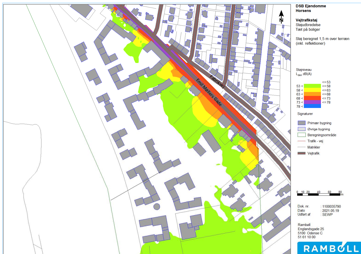
Figur 3 – Støjudbredelseskort 1,5 m over terræn, på opholdsarealer, ved indtegnede bygninger.
