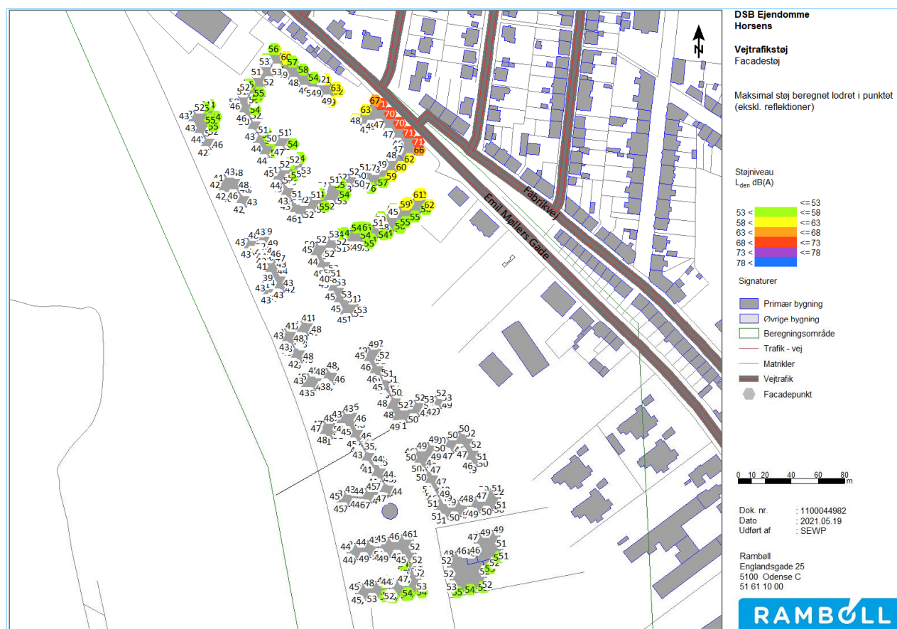
Figur 4 - Facadestøjniveauer fra vejtrafikstøj. Viser den højeste støj som er beregnet for etagerne lodret i punktet.
