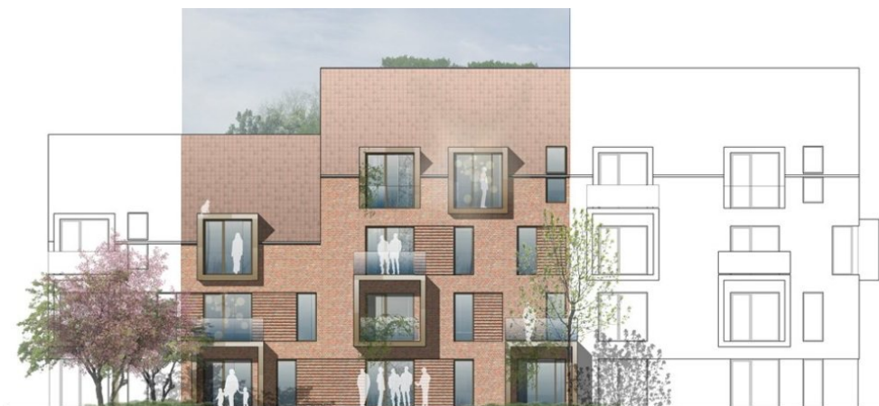
Eksempler på facadesten og murværk med reces og fremspring.
